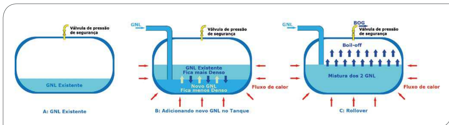
Figura 2 Geração de Boiloff devido à estratificação num tanque de GNL.
