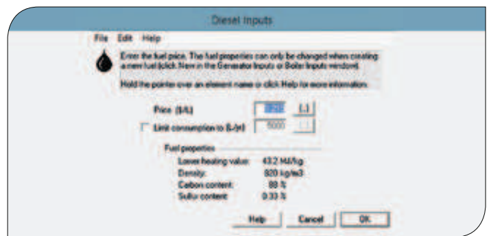
Figura 5 Janela de configuração do preço do Diesel no software Homer®.
