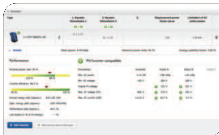
Figura 12 Janela do software Sunny Design Web com a validação do sistema fotovoltaico ligado ao 2.º inversor.
